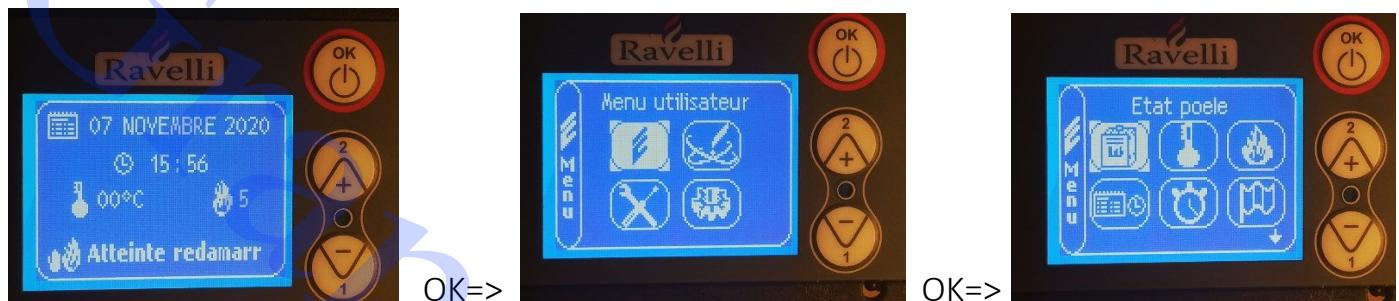
Le menu utilisateur comporte 12 menus ou icônes, 6 sont visibles 6 apparaissent en avançant. On avance dans les icônes en appuyant sur 2 (ou en tenant l'appui sur 2).
