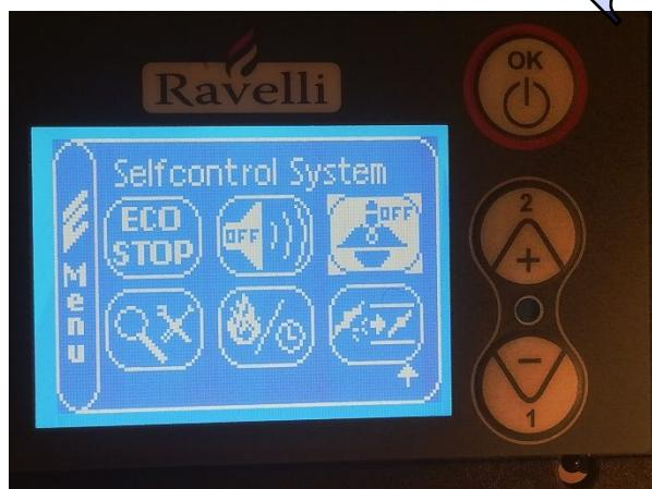
Cette fonction devrait toujours être sur OFF. En fonctionnement, la carte enregistre parfois des anomalies (flux d'air faible, t° élevée etc...). Sur Off, une minute après, l'alarme sera active, sur On, c'est instantané.
